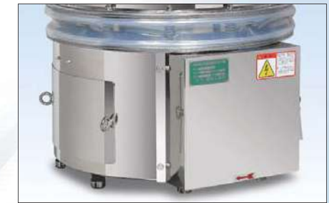
●モーターカバー モーターベース部への粉及び水の入りにくい構造になっています。
